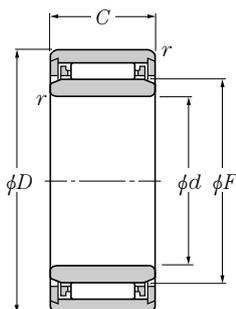
**Type NK+IR** ( $\phi d \leq 9\text{mm}$ )
