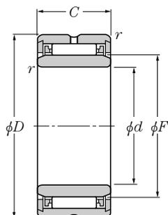
**Type NA49** ( $\phi d \leq 9\text{mm}$ )
