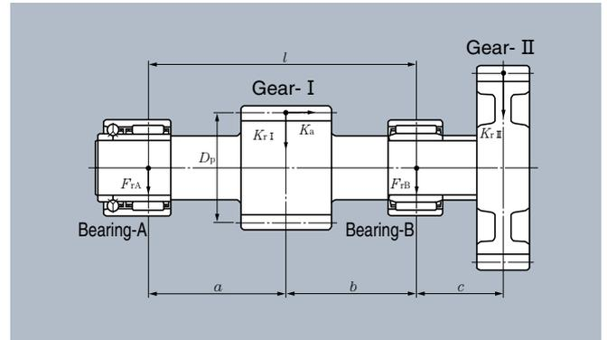
**Fig. 3.7** Gear shaft
