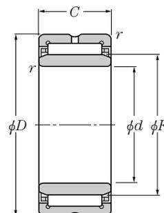
**Type NA49 · R** ( $\phi d \geq 10\text{mm}$ )
