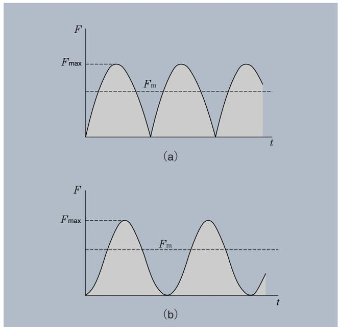
Fig. 3.11 Sinusoidal load
